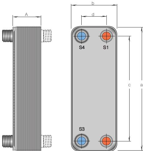
**Характеристики и размеры паяных пластинчатых теплообменников**
