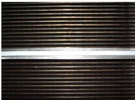
**Рисунок 18: трехгранный PTFE уплотнитель, устанавливается в желоб**
